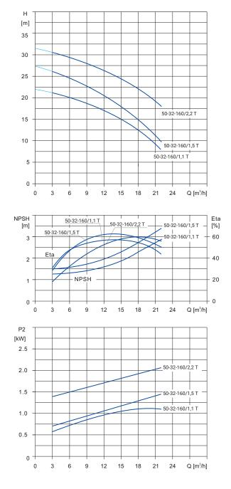
Рис.1. Пример графиков напор-расход, мощность, КПД, NPSH
