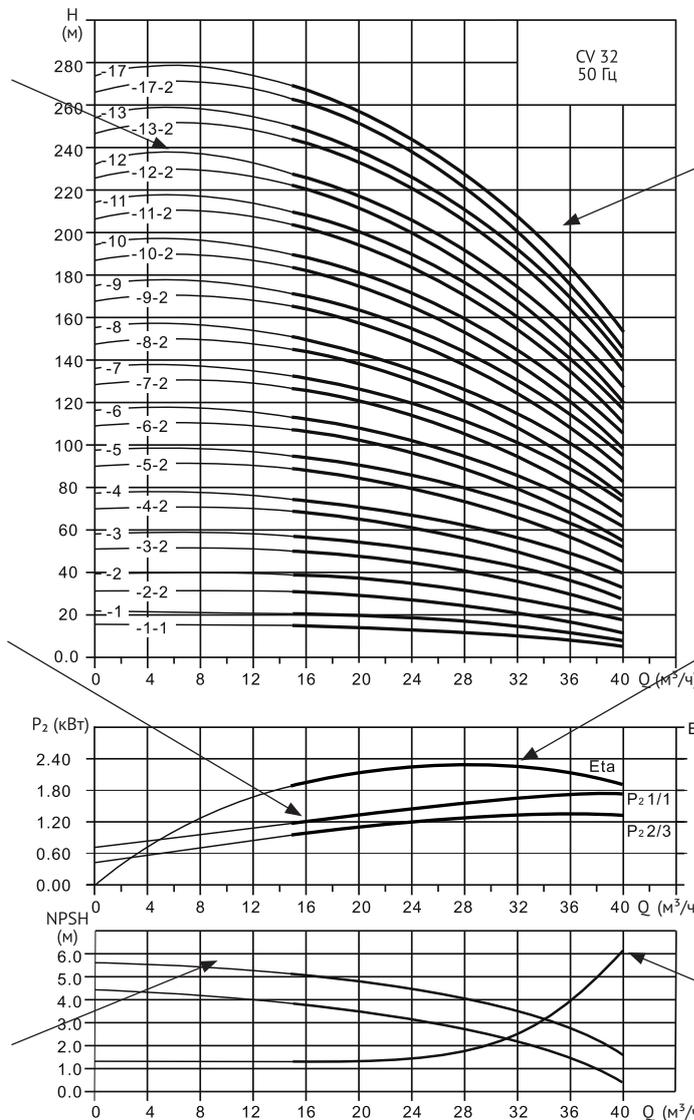
Графики характеристики  $Q$ - $H$  соответствующего насоса. Выделенная часть кривой показывает рекомендуемый рабочий диапазон с оптимальным КПД.
