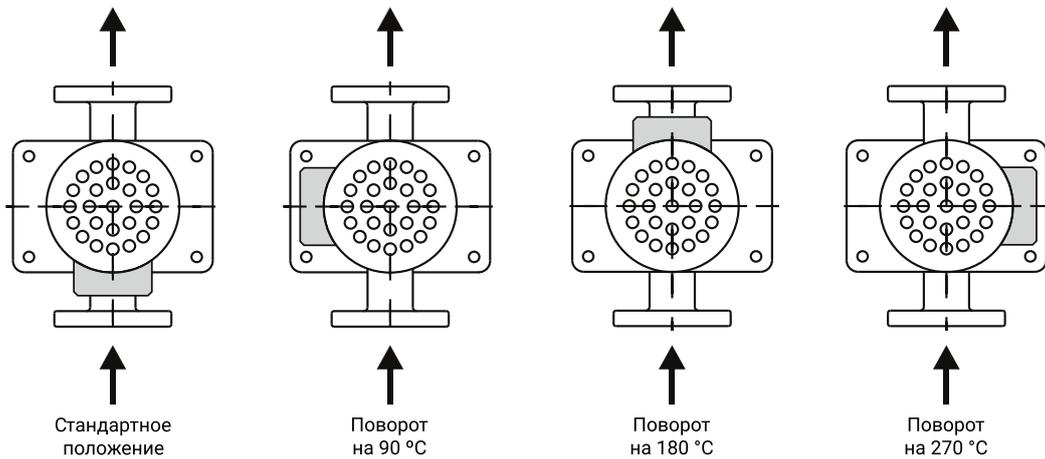
*Рис.4. Положение клеммной коробки*
