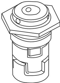
Рис.17. Картриджное уплотнение вала
