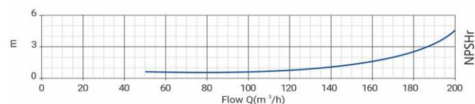
Параметры насоса рассчитаны для чистой воды плотностью 998,2 кг/м³, температурой 20 °С, вязкостью 1 мм²/с
