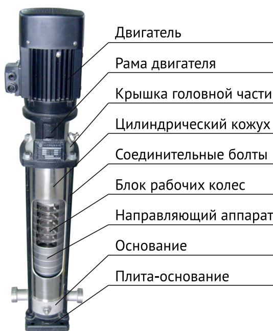
Рис. 3. Конструкция насосов
