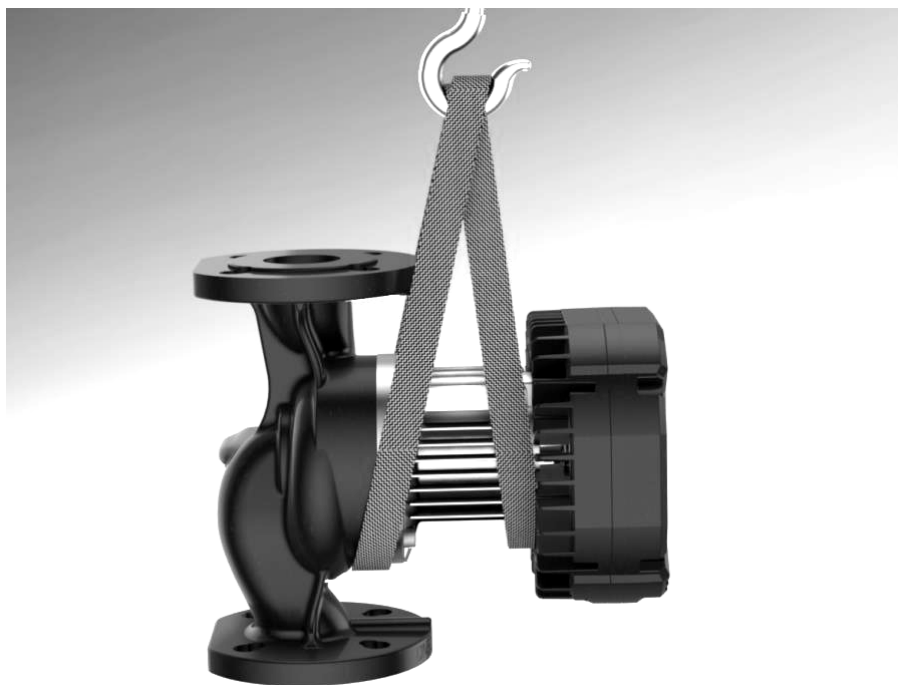
Допустимый способ строповки насоса
