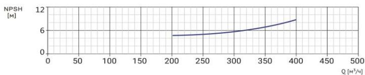
Параметры насоса рассчитаны для чистой воды плотностью 998,2 кг/м³, температурой 20 °С, вязкостью 1 мм²/с
