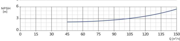
Параметры насоса рассчитаны для чистой воды плотностью 998,2 кг/м³, температурой 20 °С, вязкостью 1 мм²/с
