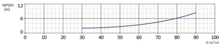
Параметры насоса рассчитаны для чистой воды плотностью 998,2 кг/м³, температурой 20 °С, вязкостью 1 мм²/с
