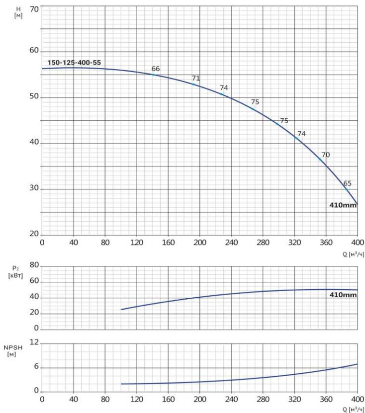
Параметры насоса рассчитаны для чистой воды плотностью 998,2 кг/м³, температурой 20 °С, вязкостью 1 мм²/с
