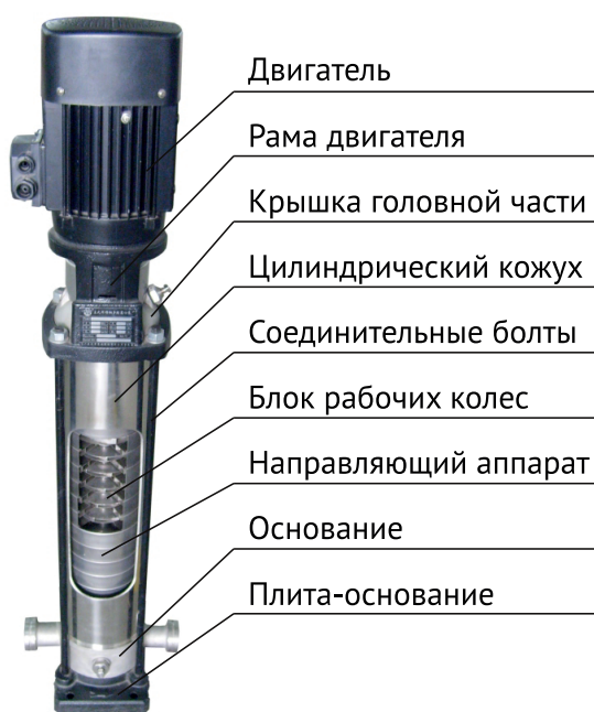
Рис. 3. Конструкция насосов
